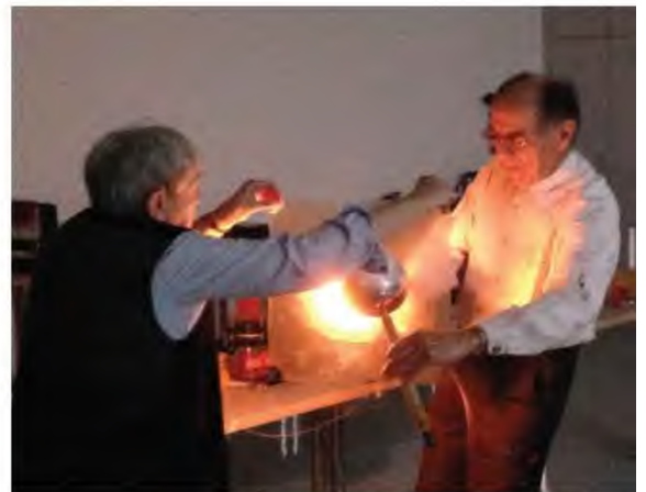
Abb. 21: Demonstration einer Gleitstielbüschelentladung an einer bipolaren Ladungsschicht von Günter und Sylvia Lüttgens [11, Seite 167]. Diese hochisolierende Folie trägt in diesem Fall die bipolare Ladung nur im mittleren Bereich, sodass sie wie im Bild mit der Hand gehalten werden kann. (Bitte nicht nachmachen!)
