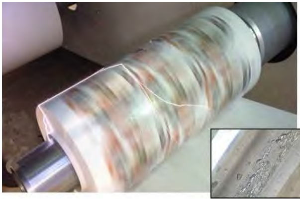
Abb. 12: Hörbare Superbüschelentladung bei der Wiederaufrüllung mit einer Bahngeschwindigkeit von 40 m/min
