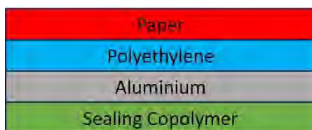
Abb. 13: Verbundwerkstoff mit eingebettetem Aluminium
