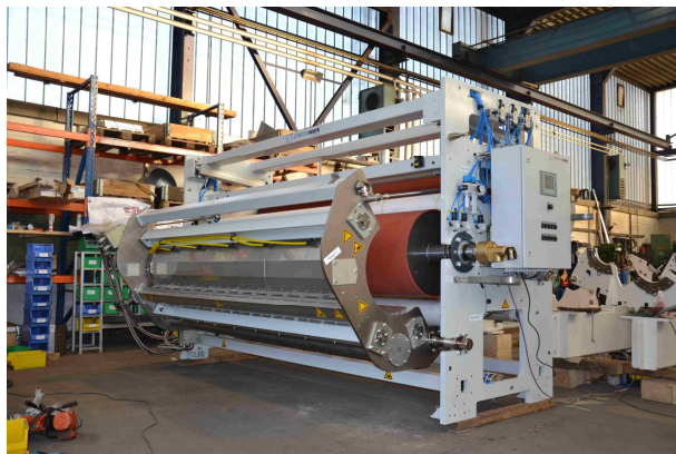
Bild 5 CAPS-Anlage, doppelseitig, für CPP
